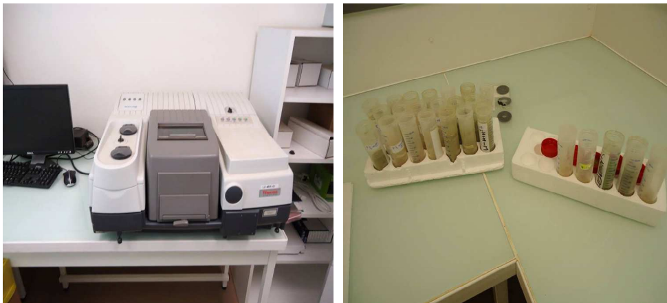
Figure 29: Photos de l'appareillage lors de la réalisation de l'analyse NIRS
