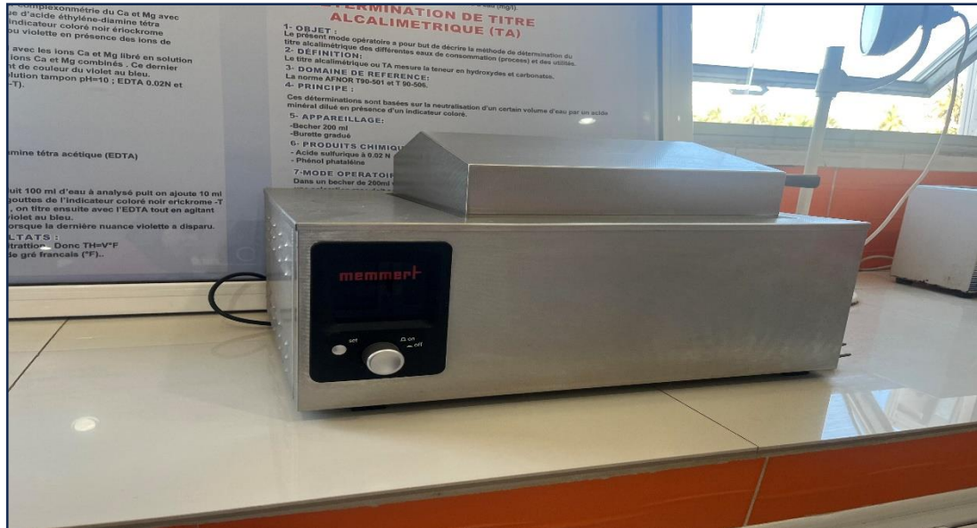
Figure 8 : Bain-marie utilisé pour les analyses physico-chimiques du lait (Mettler)
