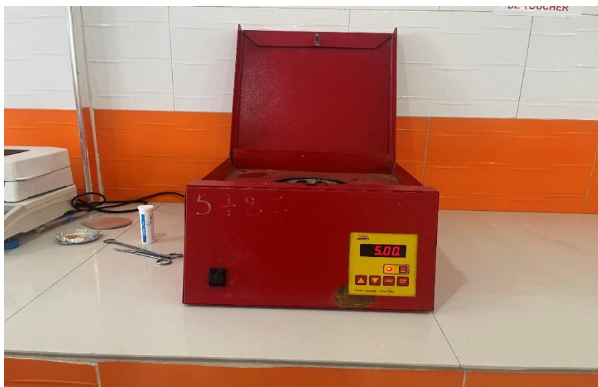
Figure 7 Centrifugeuse utilisée pour l'analyse de la matière grasse du lait
