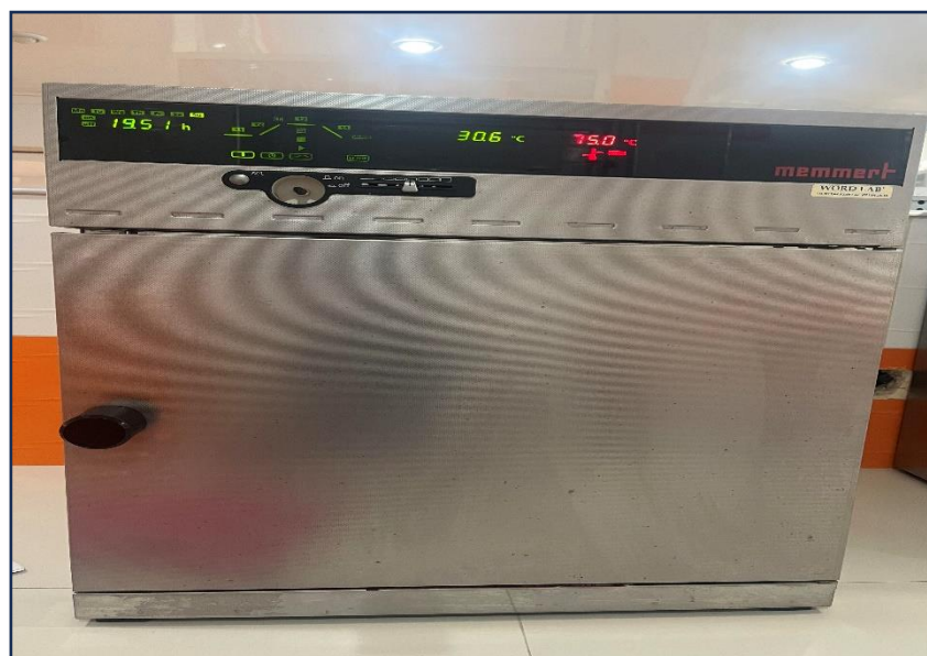
Figure 9 Étuve de laboratoire utilisée pour la déshydratation et l'incubation des échantillons
