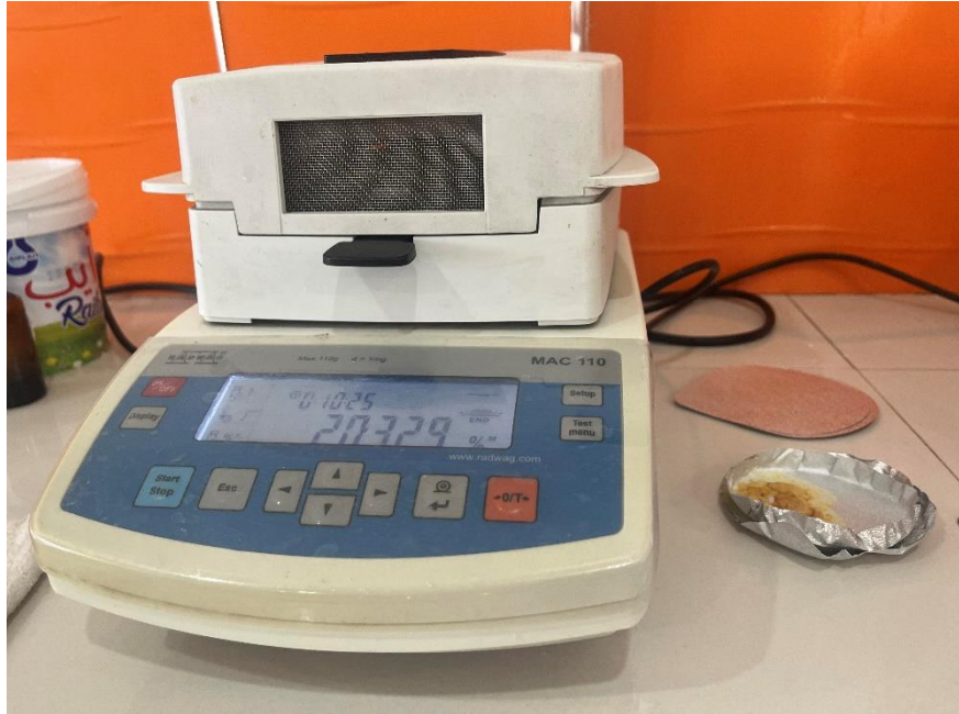
Figure 6 Balance de détermination de la matière sèche dans le lait
