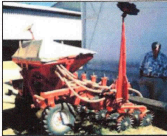
Figure 4.24 : Un semoir à poinçonneuse rotative (semoir à roue étoilée)
