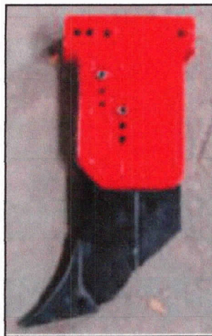
Figure 4.21 : Un chisel de type corps rayonneur pour une faible perturbation du sol.
