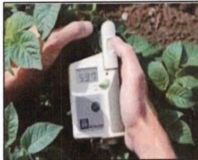
Figure 7.4 : Le N-tester permet de lire le statut azoté d'une culture d'après sa réflectance dans le rouge et le proche infra-rouge.
