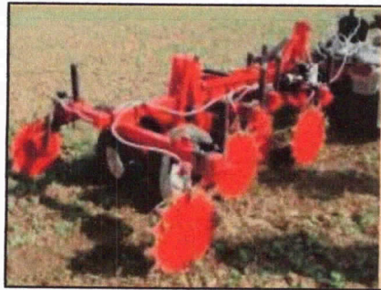
Figure 7.2 : Système ARP (Automatic Resistivity Profiling) Mesure en continu et à plusieurs profondeurs de la résistivité électrique des sols
