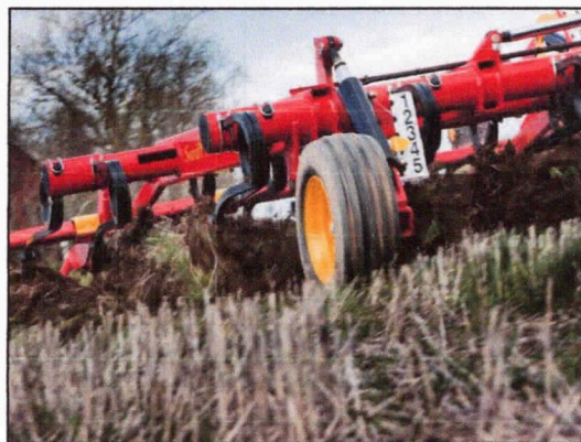
Figure 3.29 : mode d'action des dents du vibroculteur
