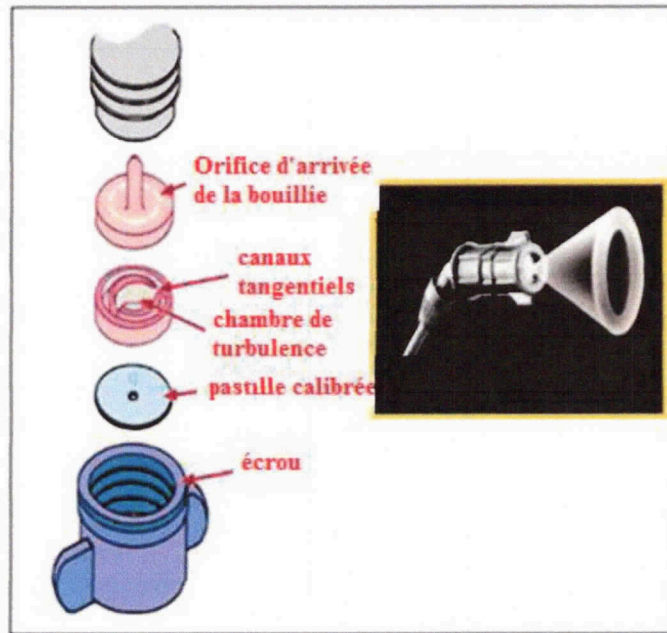
Figure 5.12 : Vue éclatée d'une buse à turbulence
