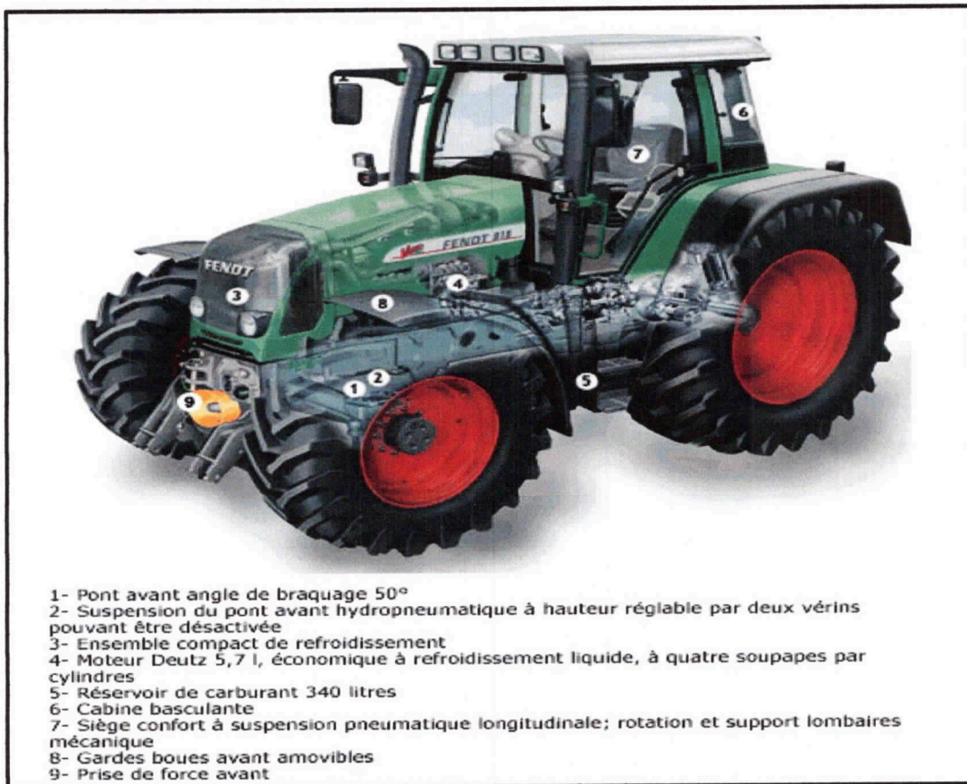
Figure 2.28 : Schéma général du tracteur agricole
