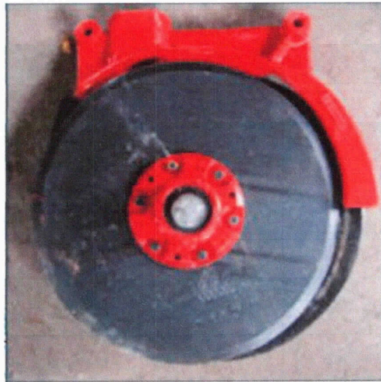
Figure 4.19 : Corps rayonneur avec doubles disques et un jeu de disques de diamètres différents.
