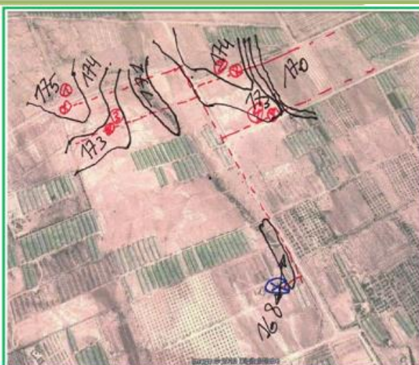
Schéma de positionnement des purgeurs en fonction des courbes topographiques
