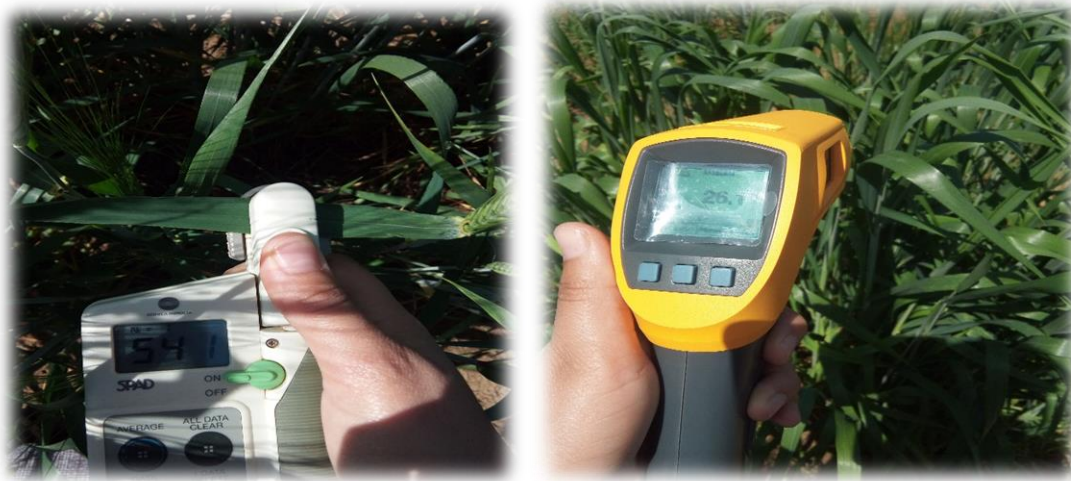
Figure 11: Détermination de la teneur en chlorophylle à l'aide du SPAD (à gauche) et la température du couvert végétal à l'aide du thermomètre à infra-rouge (à droite)
