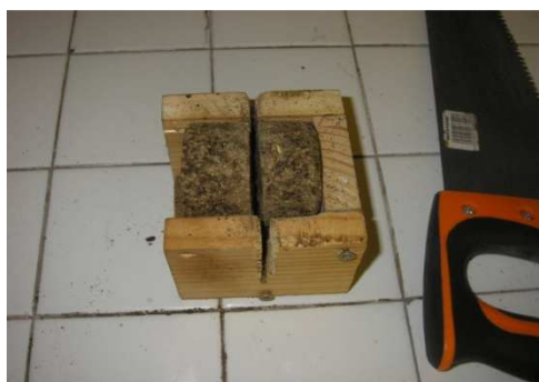
Figure 5. Dispositif manuel de découpe des pastilles. Figure 6. Profile de coupe d'une pastille
