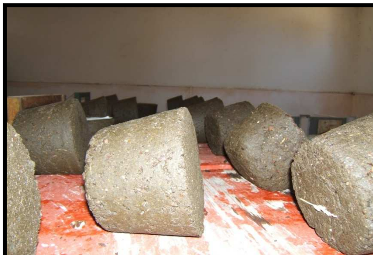
Figure 11. Blocs démoulés en cours de séchage
