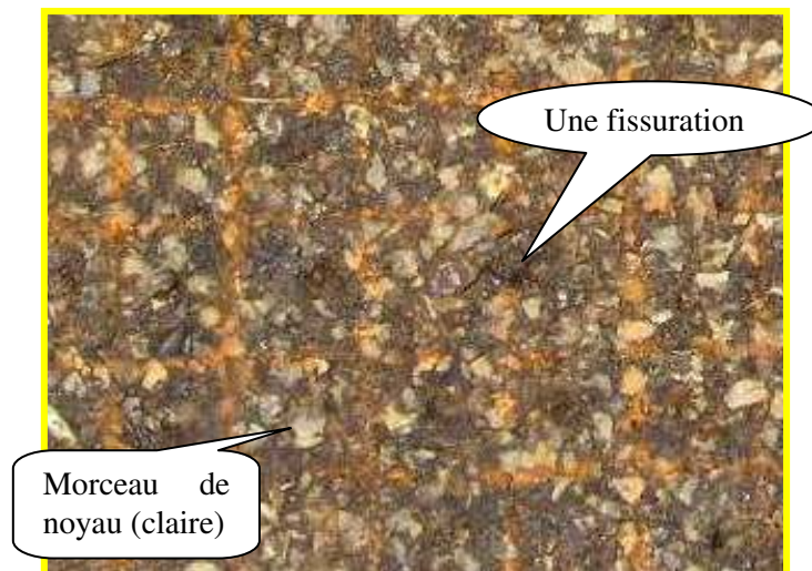
Figure 20. Zoom de la partie sélectionnée, montrant des fissurations et des grosses particules de noyau
