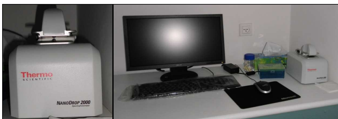
Figure 5 : le spectrophotomètre NanoDrop 2000.
