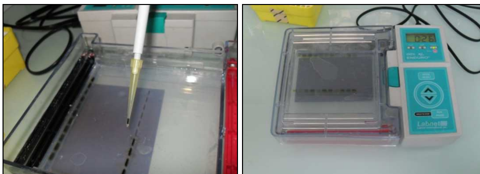
Figure 6 : dépôt des produits de l'amplification dans les puits et cuve d'électrophorèse utilisée pour la migration.
