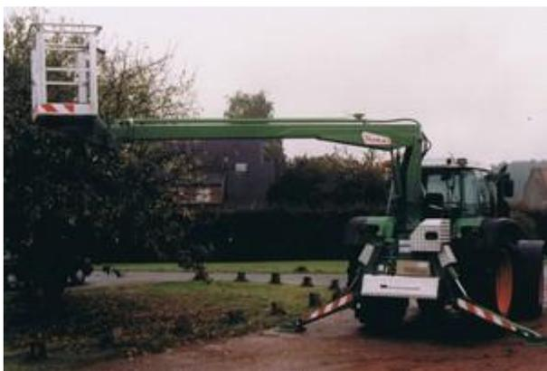
L'élévateur à nacelle Thomas, type **120NCT-12M** hauteur de travail, est un modèle très simple et pratique, se composant d'un bras télescopique qui est monté sur une tourelle mobile 400°. L'ensemble est monté sur un châssis très solide et stable doté de deux pieds de support hydrauliques. Pour montage sur tracteurs à partir de 75CH. Attelage trois-points. Très facile à
