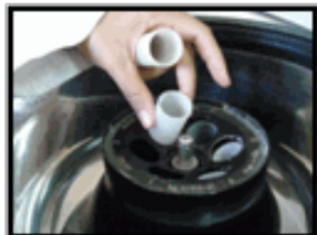
4. Centrifugation de la solution dans une centrifugeuse réfrigérée réglée à 4° C, 2000 g pendant 20 minutes
