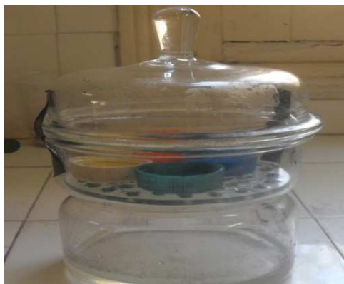
Figure n°15: Dispositif expérimental de détermination des isothermes de désorption.
