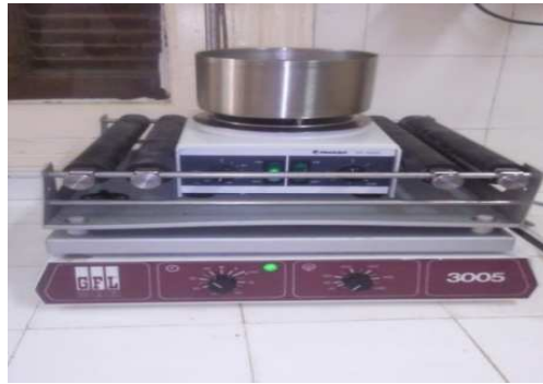
Figure n°14: Dispositif utilisé pour la déshydratation osmotique.
