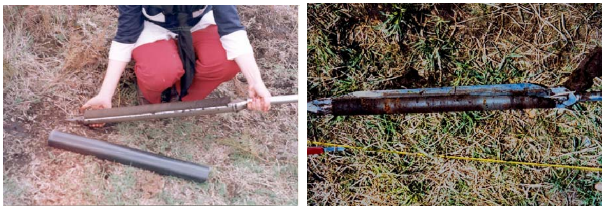
Photos. 6 : carottier Russe et carotte tourbeuse de 60cm de longueur
