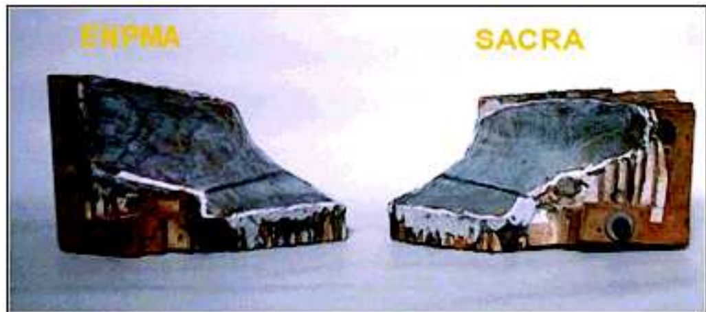
Fig.49 : Moules des surfaces actives des deux corps de charrue à l'échelle 1/ 4
