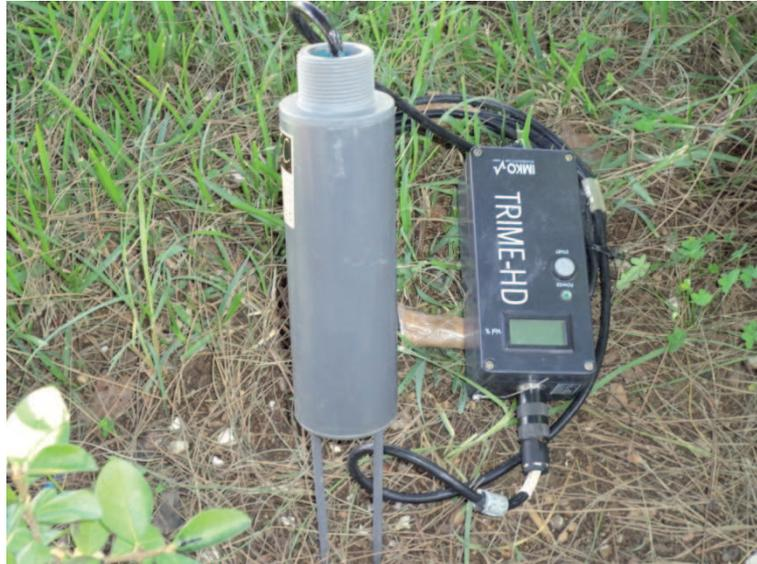
**Figure 17 :**Instrument de mesure de l'humidité de sol.
