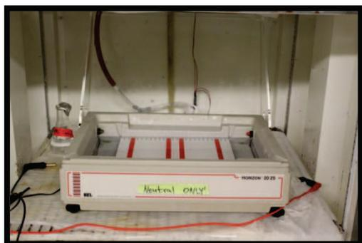
Ouverture de l'appareil et dépôt des lames entre les bandes rouges (sans brancher les prises)
