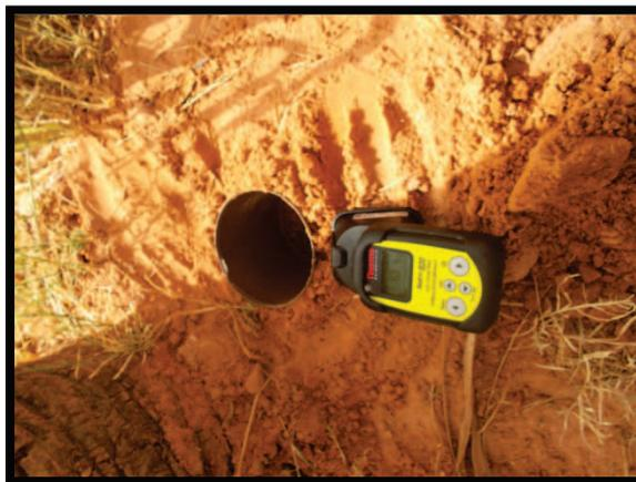
Figure 41 : Radiamètre (Originale)
