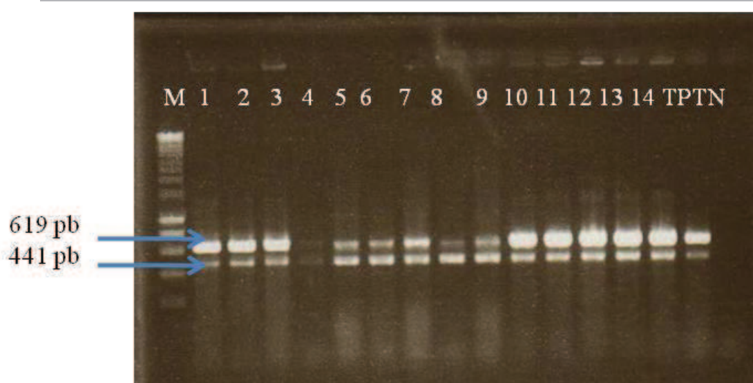
Figure 2.6 : Migration sur gel d'agarose à 1,5 % des produits PCR réalisés avec les amorces DLH120 et DLH125 (Berg et al. , 2005) et 1052-F et Bac-R (Eden et al. , 1991) sur les différentes souches isolées en Algérie
