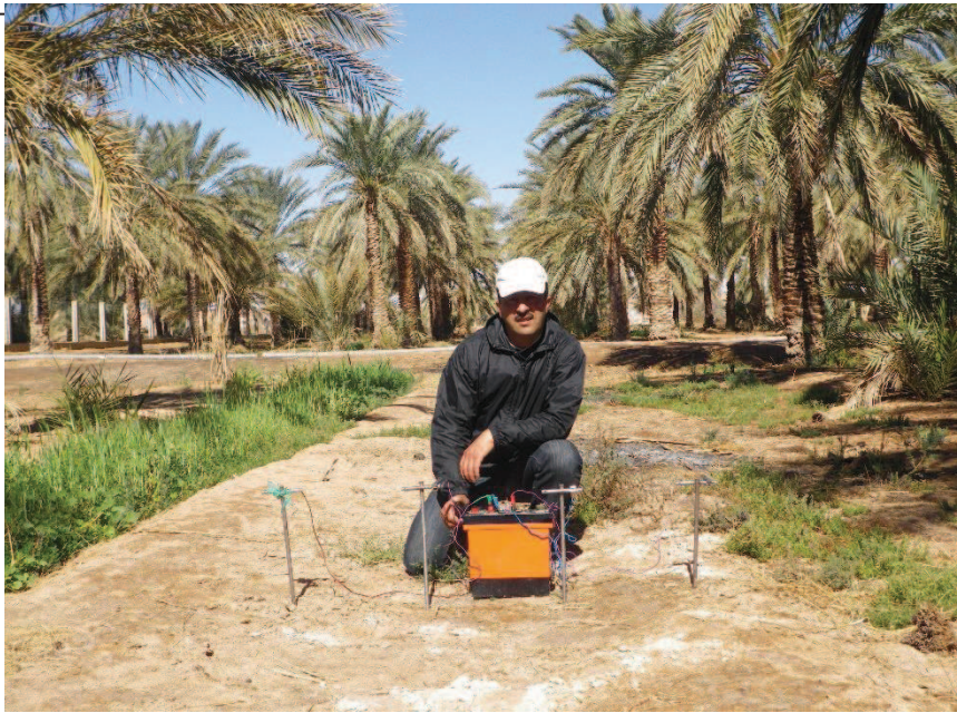
Figure 1-3. Mesure de la résistivité en mode Wenner
