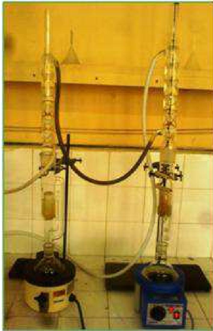
**Figure 38 :** Montage de l'appareil de Soxhlet
