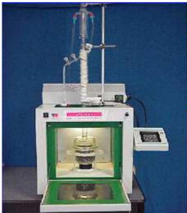
**Figure 36:** Montage de l'extraction sans solvant assistée par micro-ondes.
