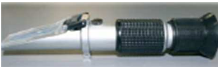
Fig. 19 - Réfractomètre portable model RHB – 90 (BRUNEAU, 2011)
