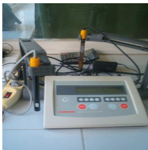
Fig. 31 - Conductimètre utilisé Model corning 442 (Photographie originale)
