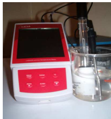
Fig. 34 - Le pH mètre utilisé Model LIDA 220 (Photographie originale)
