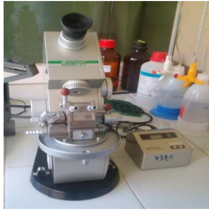
Fig. 39 - Réfractomètre utilisé model ATAGO NAR-3T (Photographie originale)
