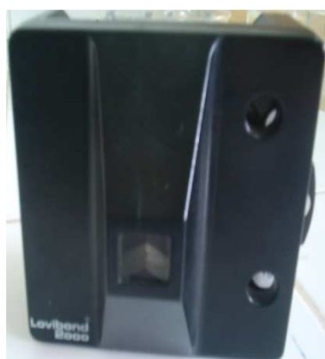
Fig. 36 - Colorimètre type LOVIBOND 2000 (Photographie originale)
