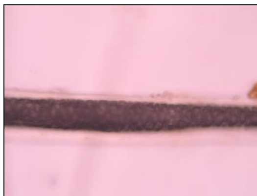
Figure 49. Image microscopique optique d'un brin de laine à gros diamètre, d'aspect creux et alvéolé sans préparation (observée au grossissement x 400)
