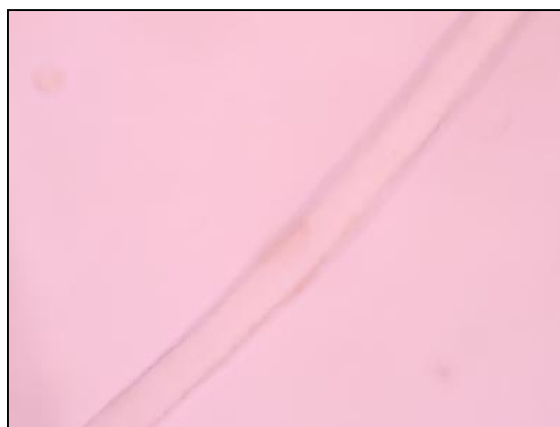
Figure 50. Image microscopique optique d'un brin de laine à fin diamètre, d'aspect plein sans préparation (observée au grossissement x 400)
