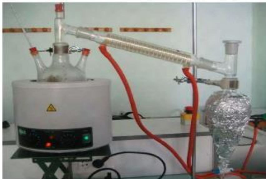
Figure 48: Montage de l'extraction des huiles par hydrodistillation.
