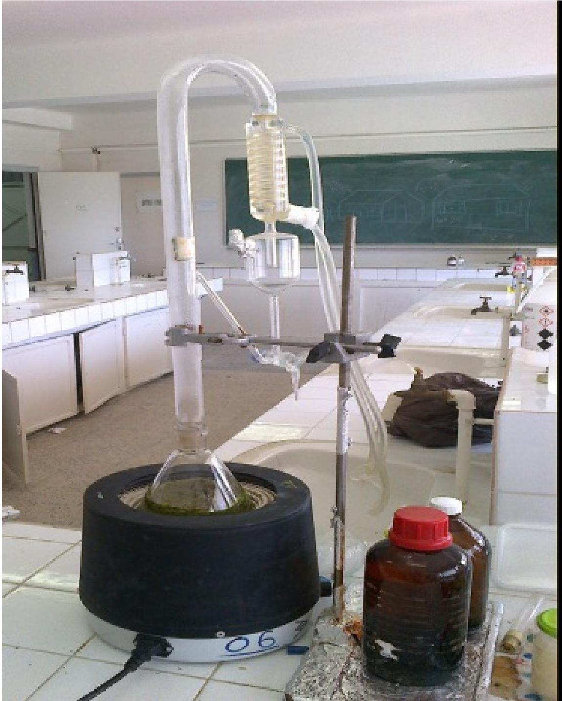
**Figure 31-** Le dispositif d'extraction Clevenger
