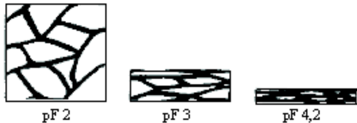
Fig. 4 – Modifications du réseau d'une montmorillonite-Ca en fonction de la teneur en eau (Tessier, 1984 ; Chamayou et Legros, 1989)
