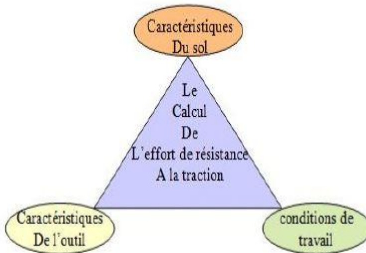
Figure 35 : Schéma synoptique montrant les caractéristiques Influ ençant l'effort de résistance à la traction
