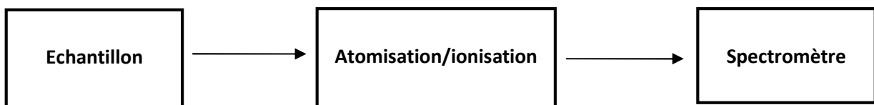
Figure 7 : Composantes de base d'un spectromètre d'absorption atomique (SAA).
