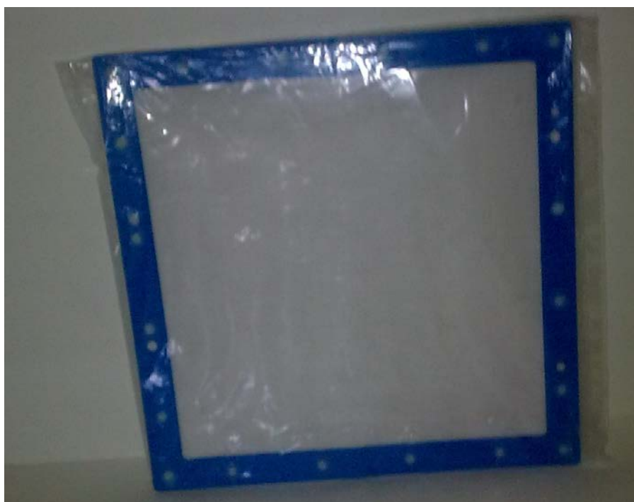
Figure 21: L'Unité filtrante verticale entière (400 cm 2 ) (Photo personnelle)
