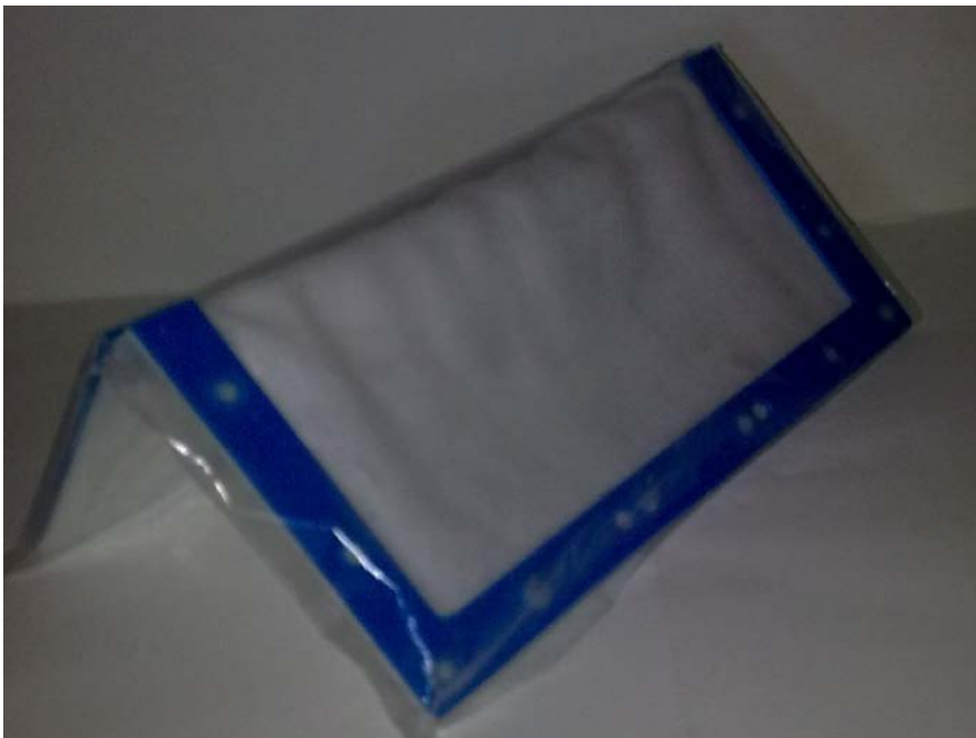
Figure 22 : L'Unité filtrante verticale (avec pré-cassure) (un demi filtre) (Photo personnelle)
