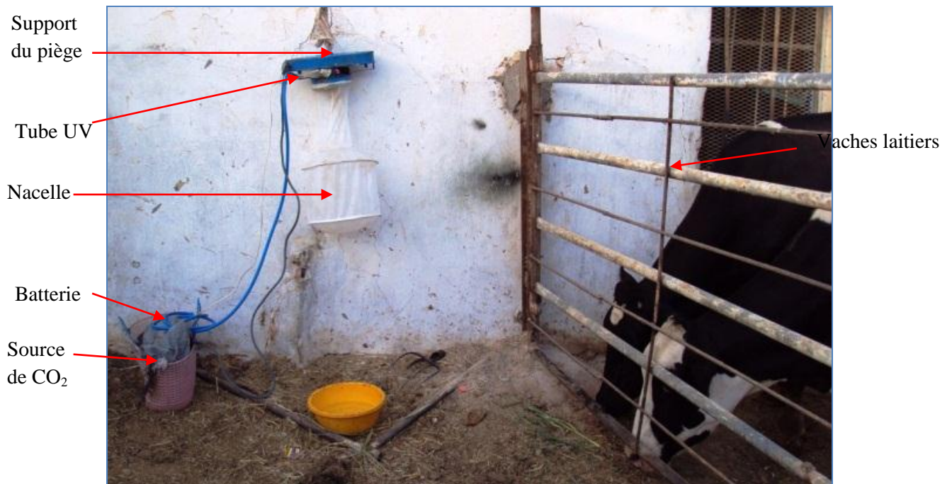
Fig. 26 – Installation du piège lumineux associé à une source du gaz CO 2 à l'intérieur d'une étable à El Guerrera (Originale)
