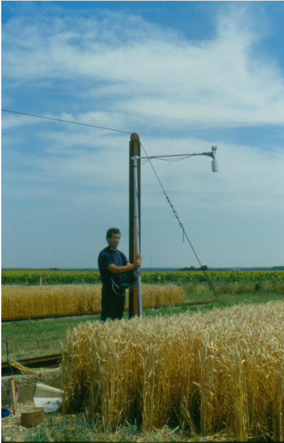
Figure 10. Photo montrant le radiomètre.
