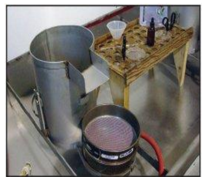
Fig. 20- Appareil de Fenwick modifié (BELAIR et SIMARD, 2009).
