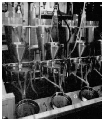
Fig. 19- Elutriateur semi- automatique (BARKER et al., 1976)
