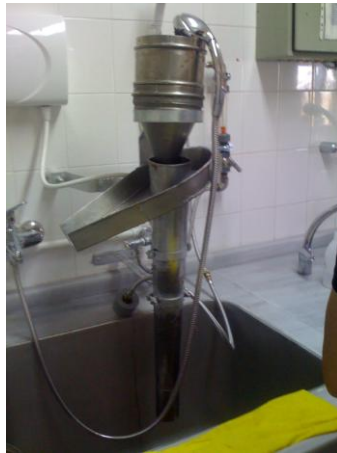
Fig. 16- Appareil d'Oostenbrink (1960) (originale).
