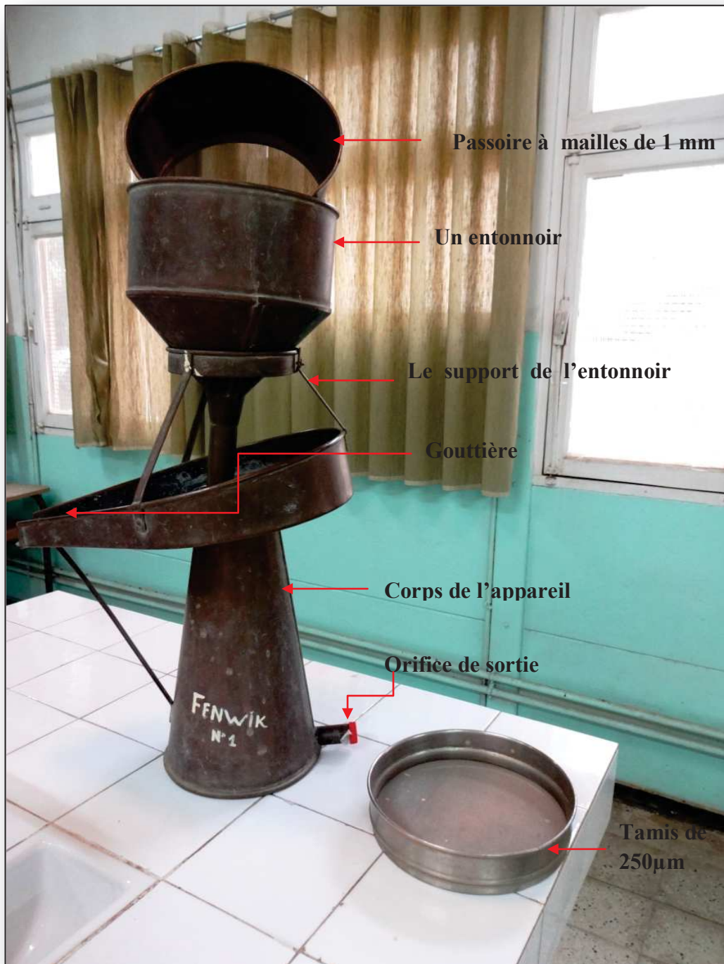
Figure 26: Composition de l'appareil de Fenwick (Original)
