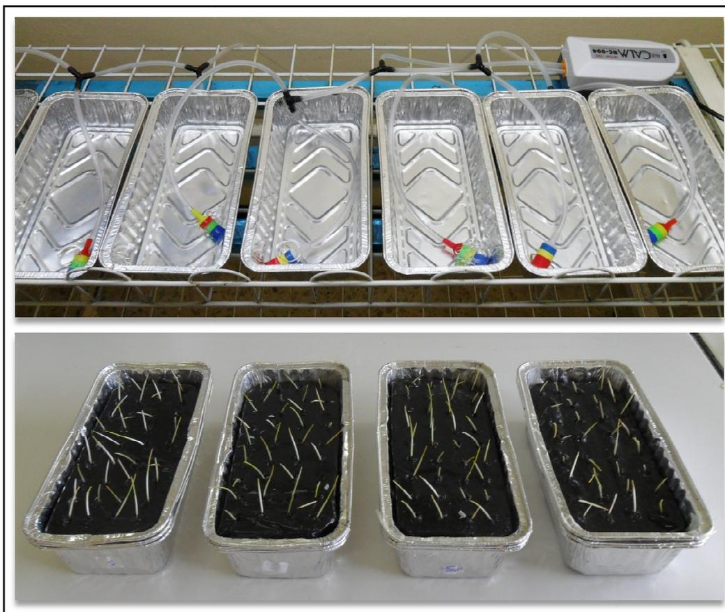
**Figure 16.** Système d'oxygénation de la solution nutritive et de culture hydroponique.
