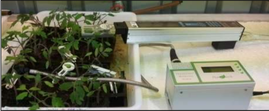
Figure 21: Dispositif de mesure de la fluorescence chlorophyllienne.
