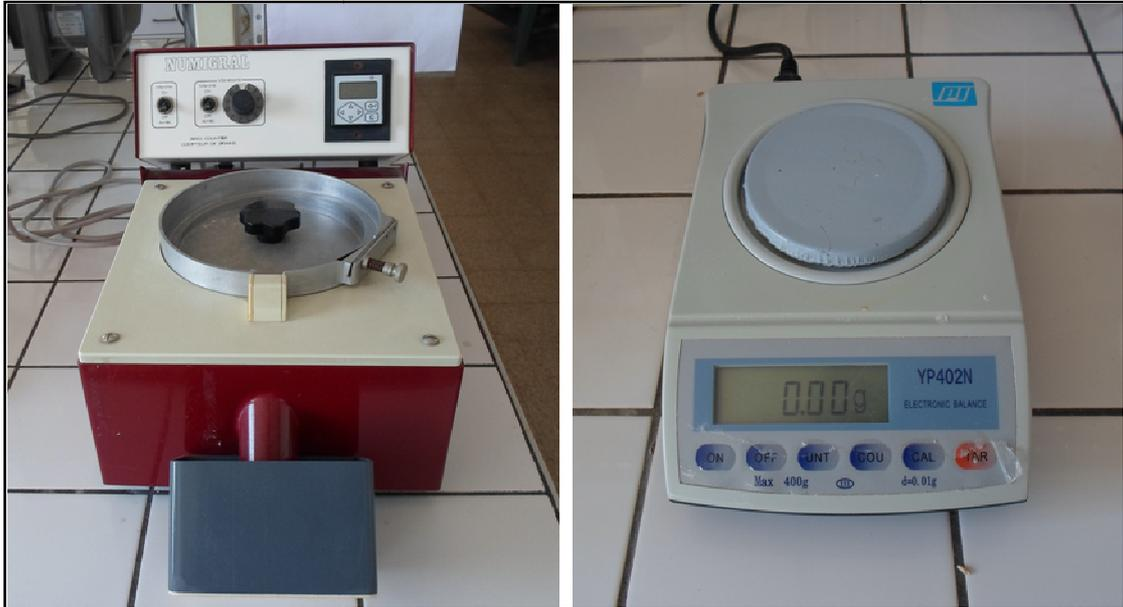
**Figure 15.** Compteur de grains (à gauche) et balance de précision (à droite).
