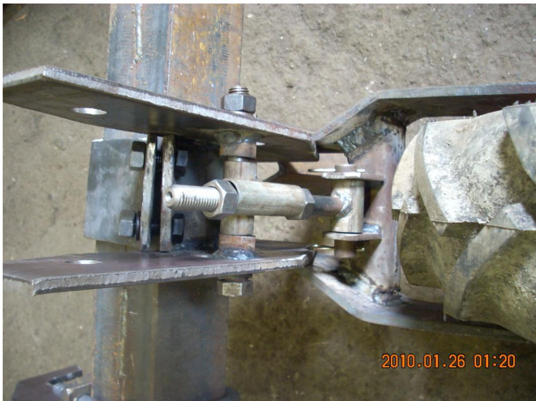
**Photo 6 :** Vue de système régleur, bloc roue
