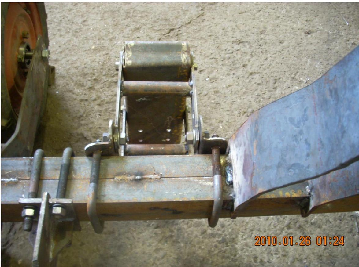
**Photo 8 :** Emplacement de parallélogramme sur châssis.
