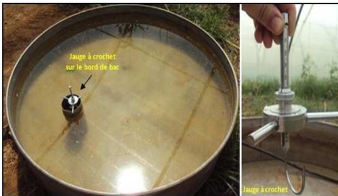
Figure 39 : Mesure de l'eau évaporée dans le bac à l'aide de la jauge à crochet
