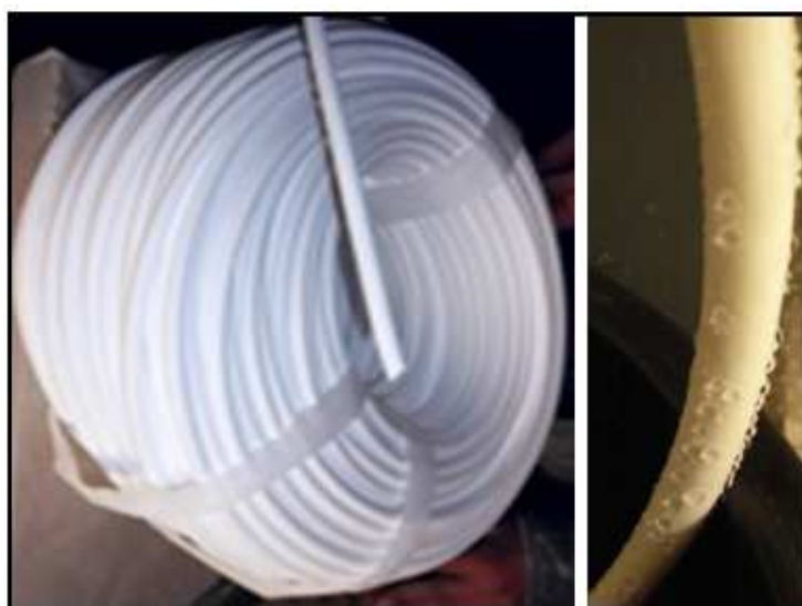
Figure 23 : Hydrophilisation des conduites ARSIT
