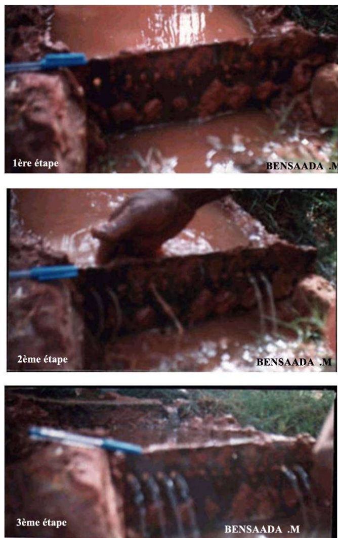
Photo.15 : La mesure du débit de l'eau par la plaque de jauge
