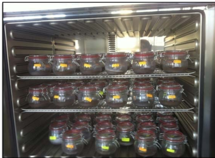
Fig.4.2.1. Mise en place des échantillons du sol dans des flacons en verre dans un incubateur à 28°C
