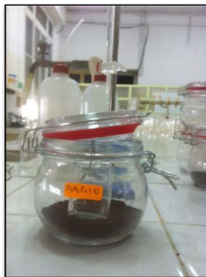
Fig. 4.2.2. Flacon en verre contenant le sol et le pilulier de la solution de soude
