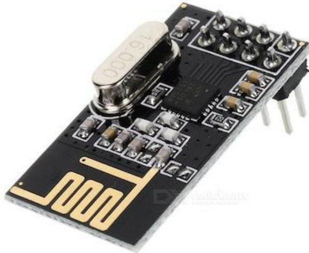
Figure 32 : Module nRF24L01
