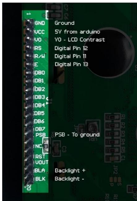
Figure 25 : Brochage du module LCD 128x64
