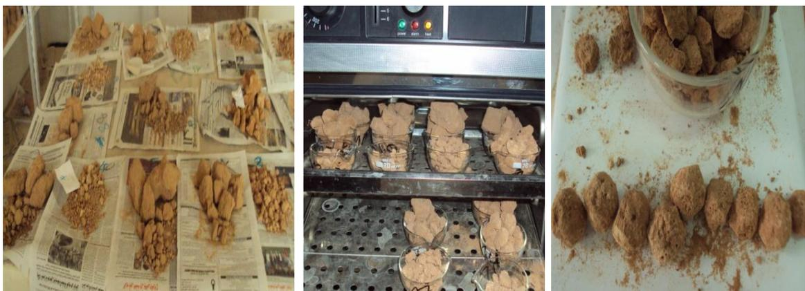
Photos 9, 10 et 11. Préparations des échantillons à la mesure de la résistance à la traction.
