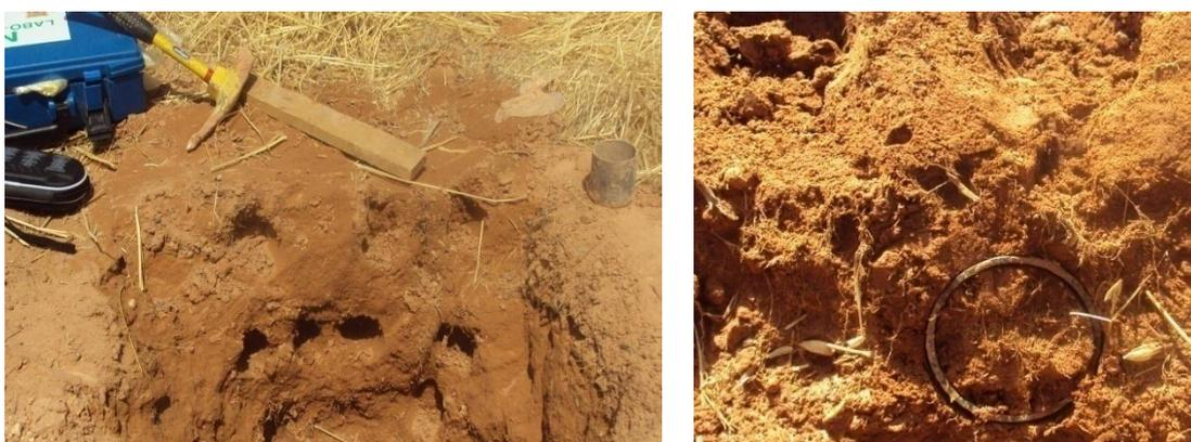
Photos 12 et 13. Les mesures de la densité apparente sur terrain.
