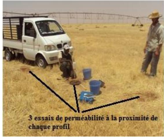
Photos 7 et 8. Déroulement de l'essai de la perméabilité hydraulique.
