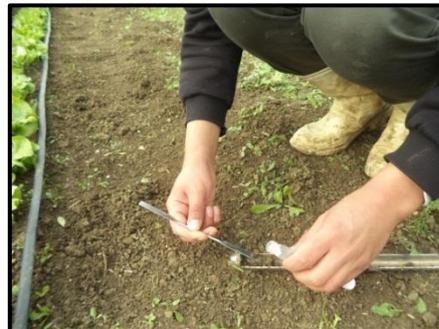
**Figure 11.** Prélèvement des échantillons à l'aide d'une tarière pédologique
