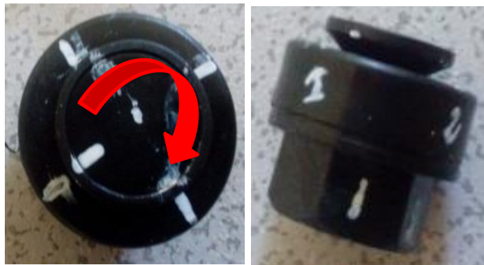
Figure 63: traçage des repères sur les microdiffuseurs pour faciliter le réglage.
