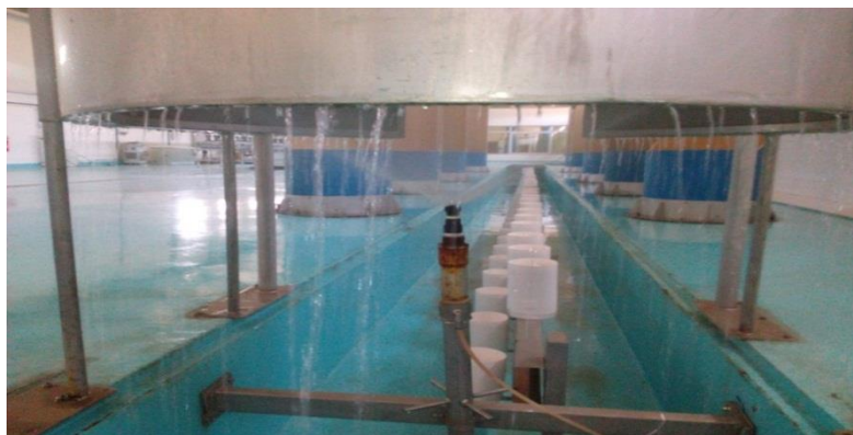
Figure 18: Microdiffuseur monté sur banc d'essais et mise en essai.
