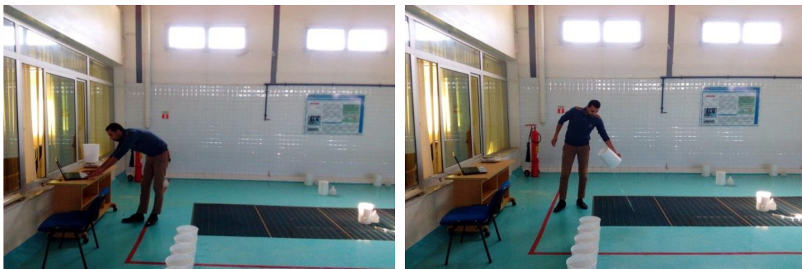
Figure 21: Pesée des pluviomètres avant et parés essais et enregistrement sur place des résultats.
