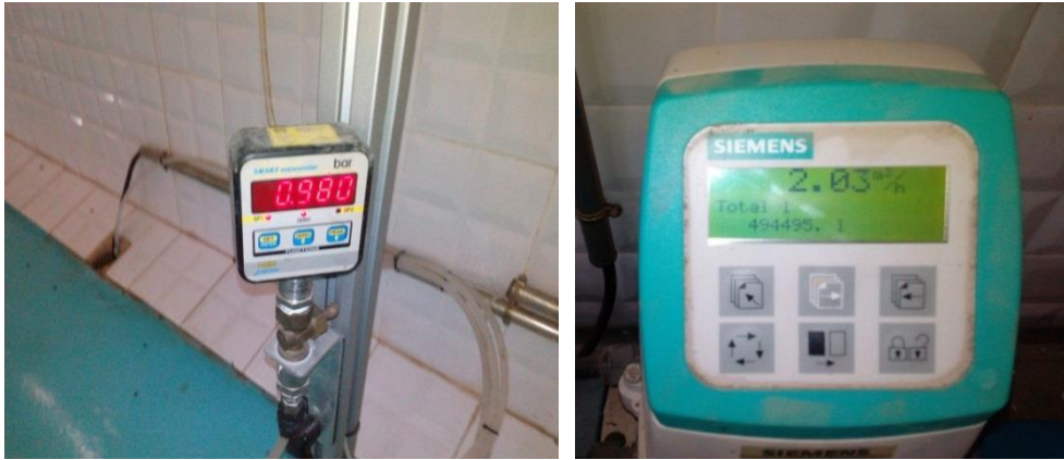
Figure 17: Application des pressions de pressions de 1 à 4 bar et enregistrement des débits.
