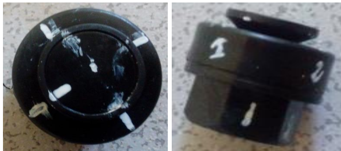
Figure 16: Traçage des repères sur les microdiffuseurs.
