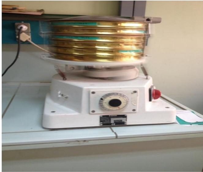
**Figure 7 :** Planschister de laboratoire BHULER
