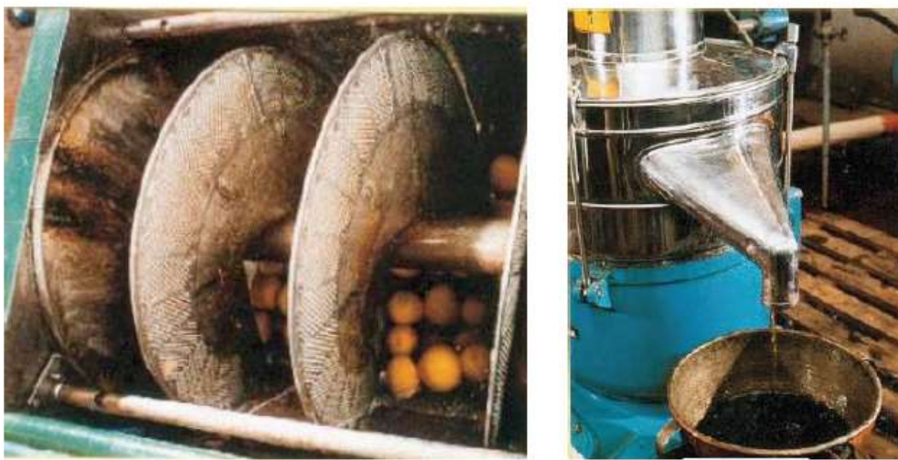
Figure 9 : Photos à gauche d'une Pelatrice et à droite d'une centrifugeuse séparatrice de l'essence de citrus des eaux résiduelles.
