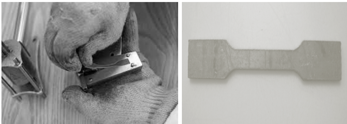
Figure 16 : Préparation des éprouvettes plastiques pour essai de traction.
