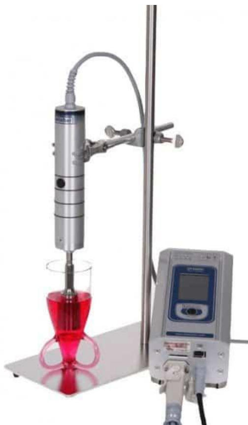
Figure 17 : Dispositif d'extraction assistée par ultrasons
