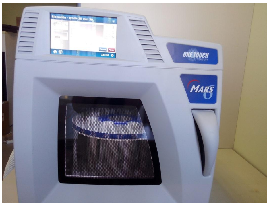
Figure 18 : Dispositif d'extraction assistée par micro-ondes.
