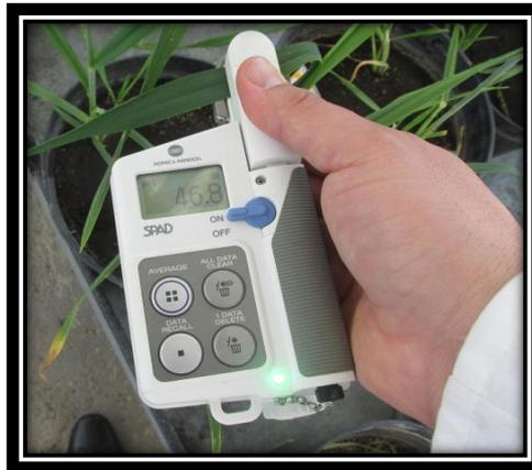
**Figure 19:** Prise de mesure avec chlorophylle-mètre SPAD 502.
