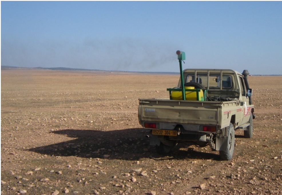
Fig. 64 : Micronaire AU7000 monté sur une Toyota LandCruiser
