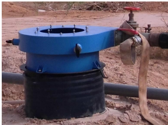
C. Bloc Turbine et le puit d'écoulement
