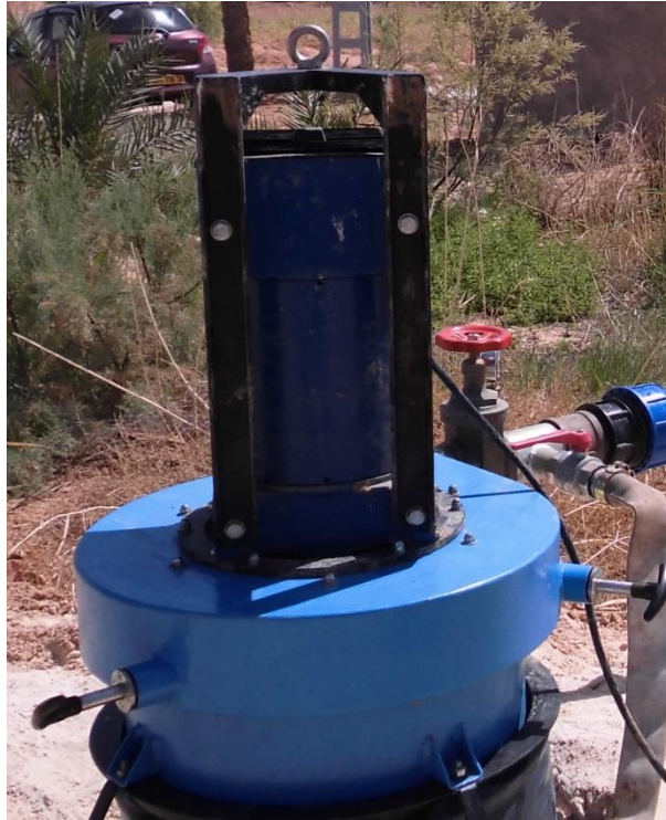
Figure 29 : La microcentrale hydroélectrique utilisée.
