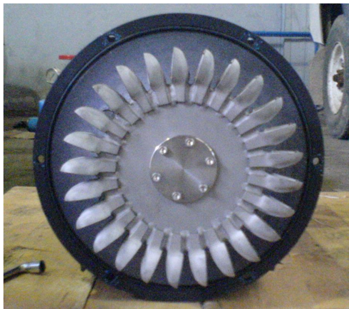
Figure 30 : La roue Pelton de la microcentrale hydroélectrique
