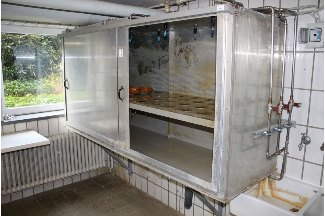
Figure 3 : La chambre mistifier utilisée pour l'extraction de J2s de Meloidogyne sp. (Originale)
