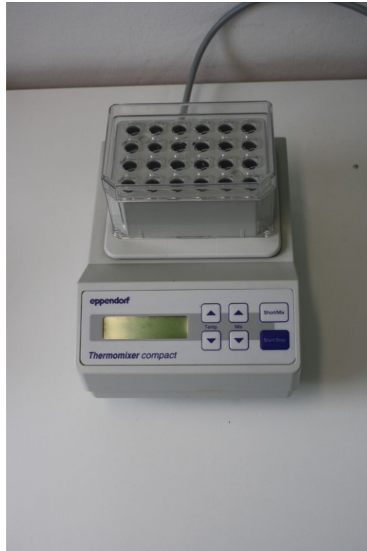
Figure 7 : Thermomixeur utilisé durant l'extraction de l'ADN (Originale).
