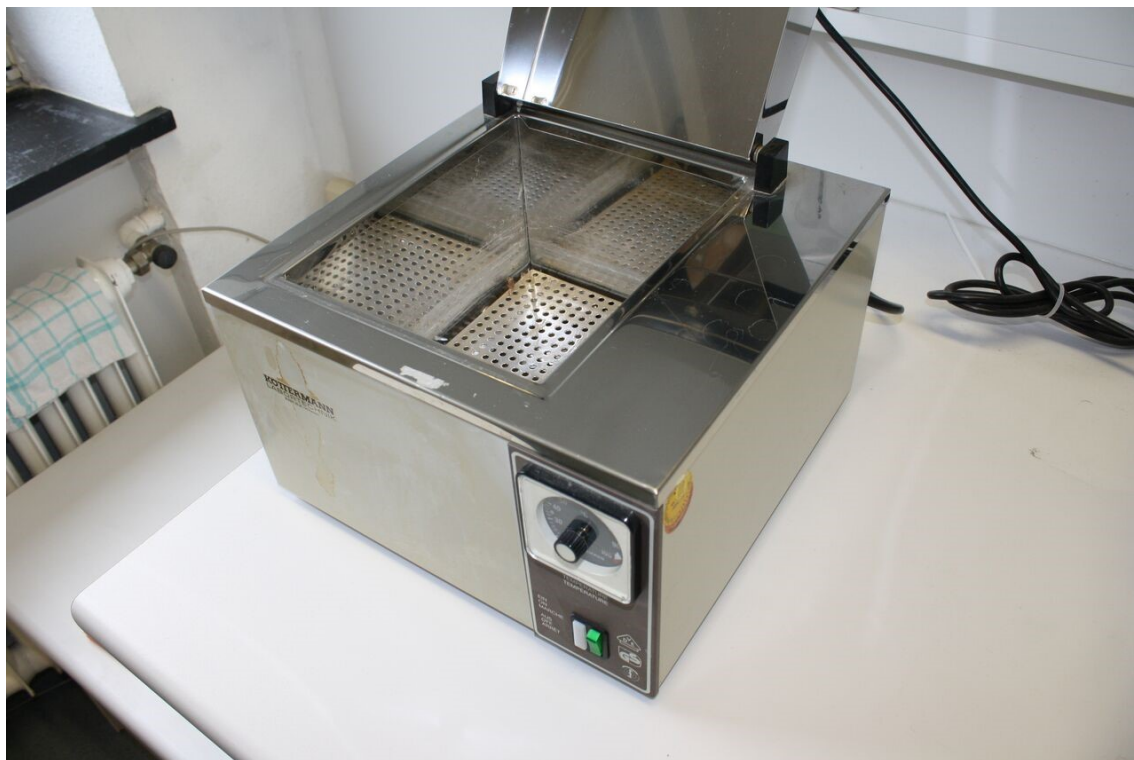
Figure 31 : Bain d'eau utilisé dans la concentration des extrais aqueux et éthanoliques (Originale)
