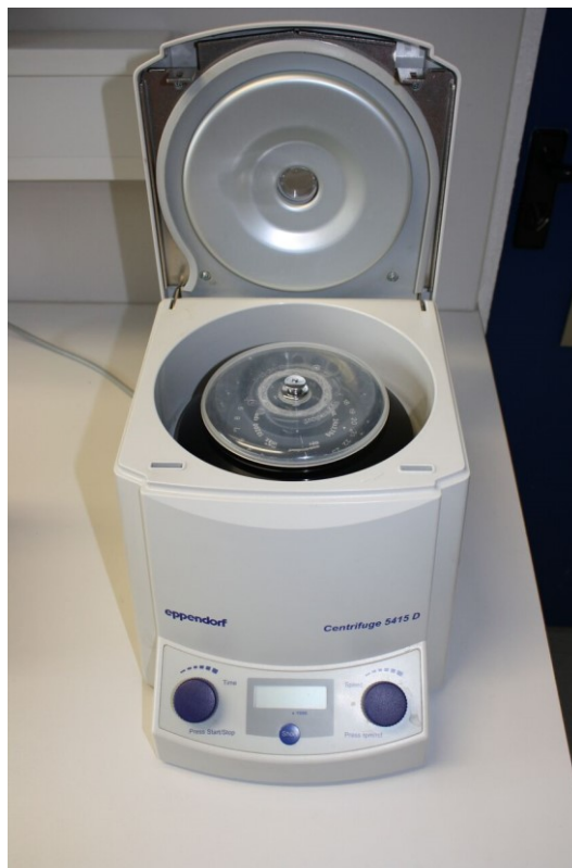
Figure 6 : Centrifugeuse utilisée pour centrer les nématodes au fond des tubes eppendorfs (Originale)
