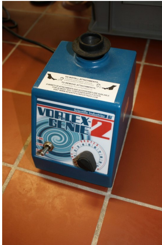
Figure 5 : Agitateur vortex utilisé durant l'extraction de l'ADN (Originale)
