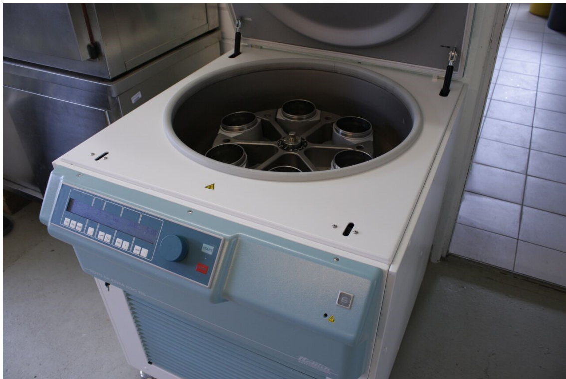
Figure 30 : Centrifugeuse utilisée pendant l'extraction des J2 afin de séparer les débris végétaux de la solution des J2s (Originale)
