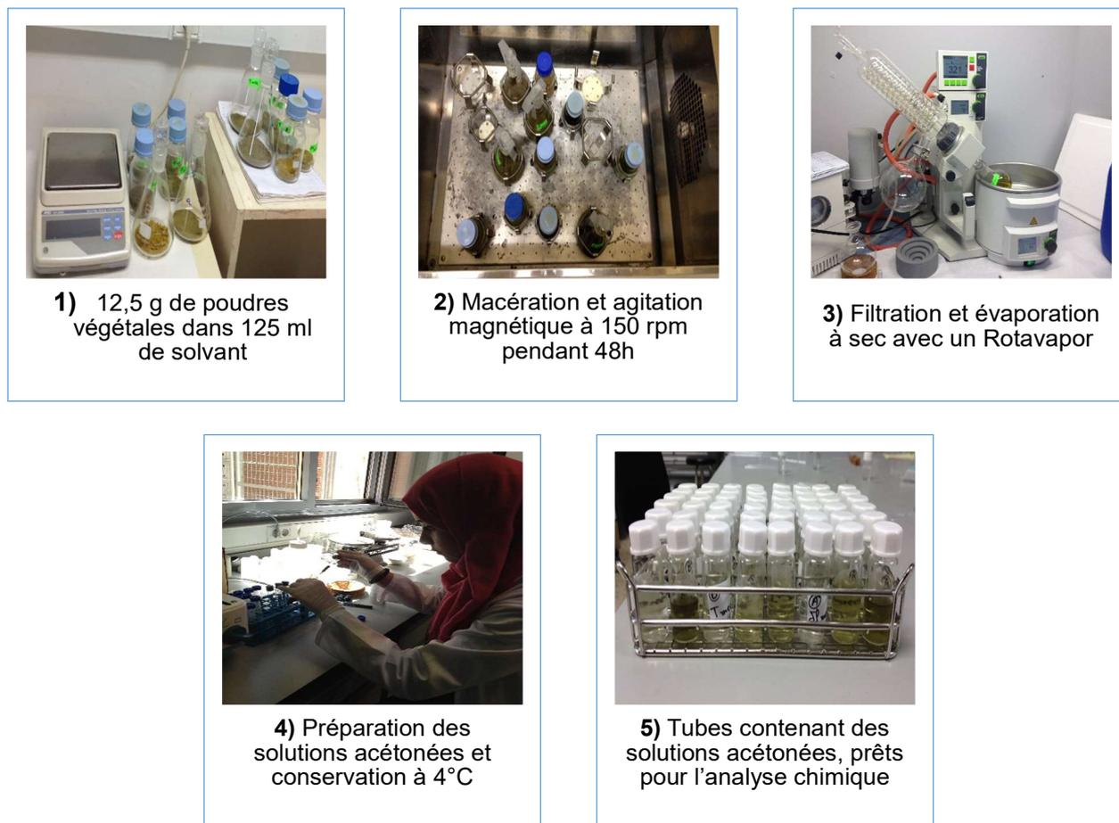
**Figure 18.** Schéma du processus d'extraction méthanolique (Original)
