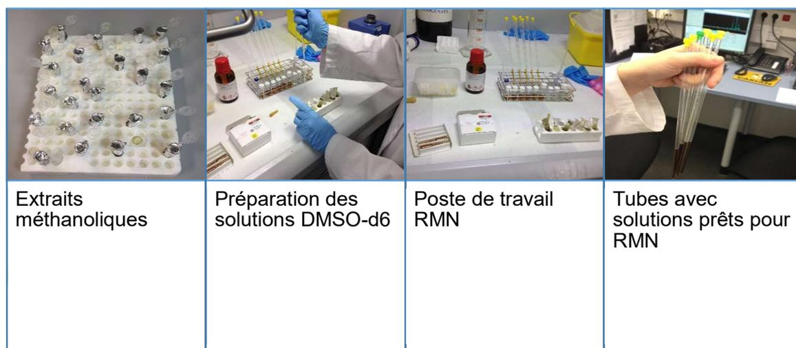
**Figure 22.** Analyse des extraits méthanoliques par  $^1\text{H}$ -RMN (Original)
