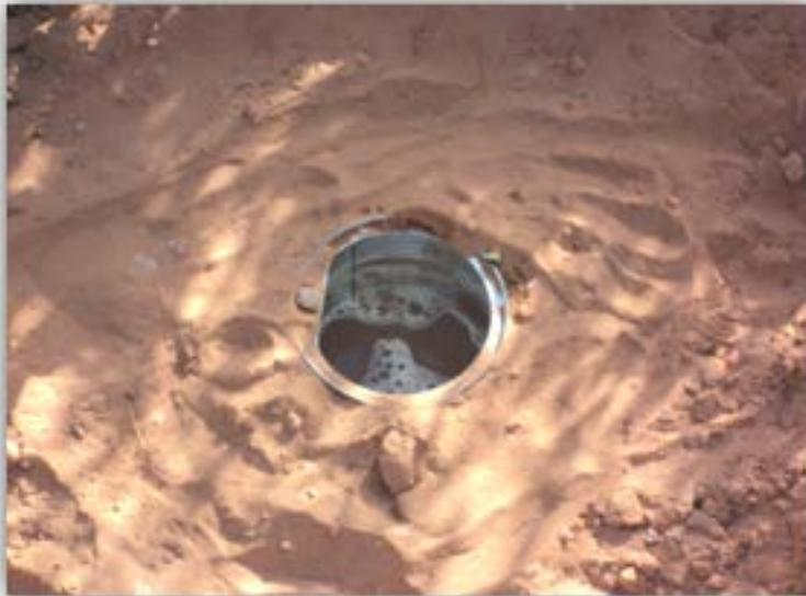
**Figure 16-** Mise en place des pots Barber (Original)
